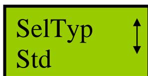
Utilizzando i tasti (3) e (4) sulla riga inferiore del display appariranno sequenzialmente le diciture **Std** (Classe A1R) o **High** °C (classe B).
