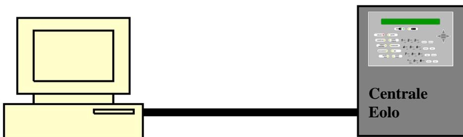
Questi tipi di configurazioni vengono effettuati tramite un cavo seriale che collega direttamente l'host computer alla centrale tramite il connettore P1. Vengono utilizzate per:
