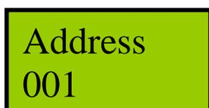
Utilizzando i tasti (3) e (4) sarà possibile modificare l'indirizzo che appare nella riga inferiore del display. Una volta modificato l'indirizzo premendo il tasto (1) si effettuerà la programmazione del device, la quale se andrà a buon fine farà accendere il led verde fisso sul device stesso.
